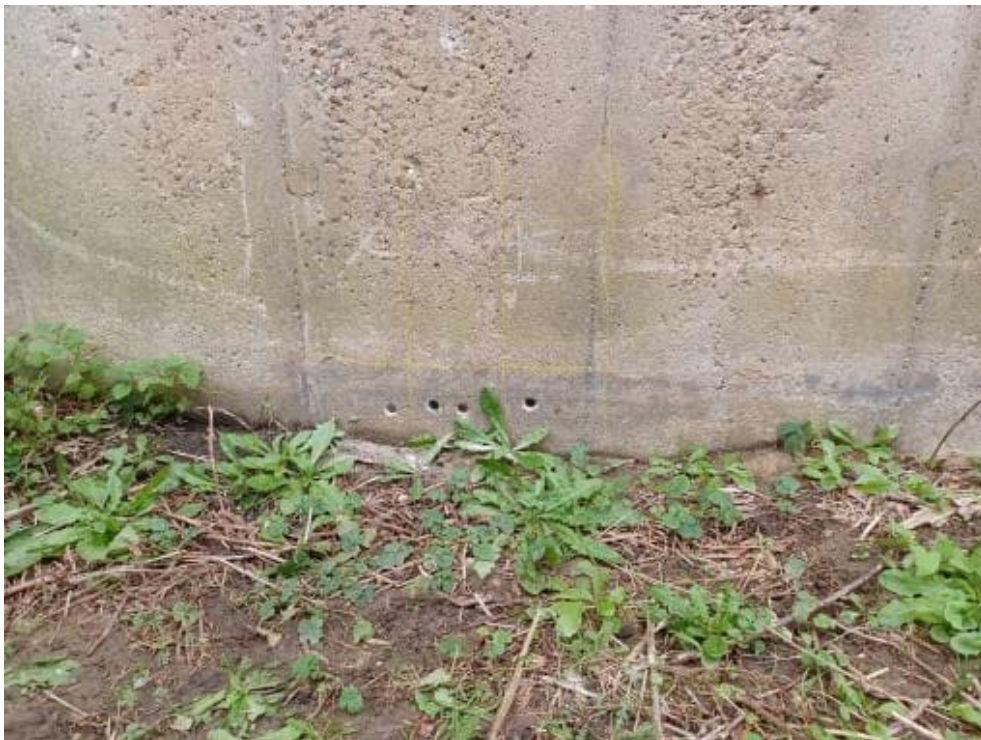
Bild 12: N8 Bohrmehlentnahme 0-20, 20-40 mm CI 3.1 und 3.2
