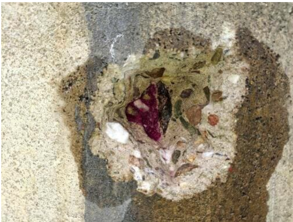
Bild 52: N28 Karbonatisierungsprüfung K4, K \geq 38\text{ mm} , Betondeckung c = 42\text{ mm}
