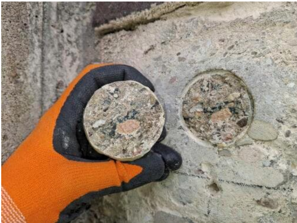
Bild 122: N54 Haftzugprüfung HZ9, ID 119, Abreifestigkeit 5,21 N/mm² Versagensbild: 100% Kohäsion
