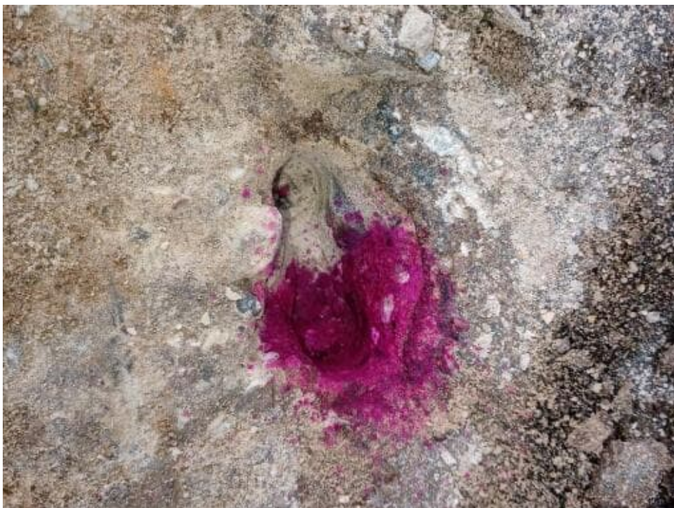
Bild 40: N23 Bohrmehlentnahme 0-20, 20-40 CI8.1 und CI8.2, Karbonatisierung K < 1\text{mm} Kragplatte, Mörtel vorher entfernt
