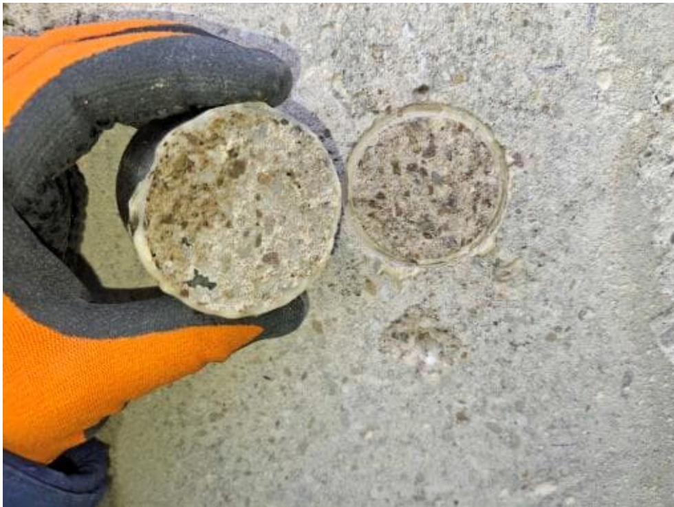
Bild 73: N36 Haftzugprüfung HZ4, ID 114, Abreißfestigkeit 3,06 N/mm 2 Versagensbild: 90% Kohäsion 10% Adhäsion
