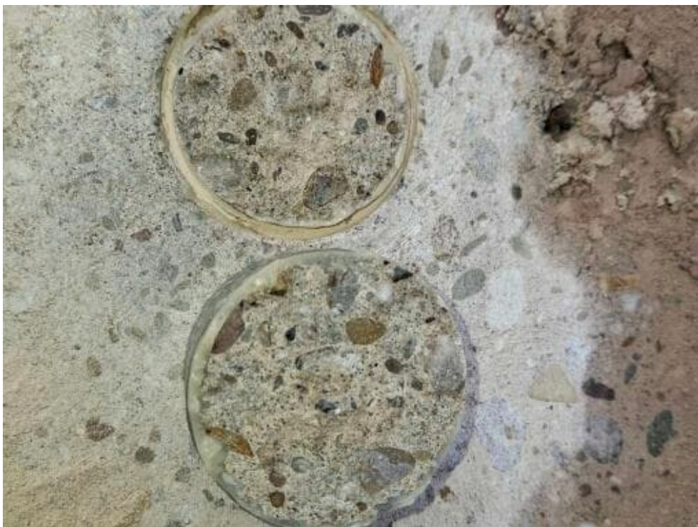
Bild 136: N59 Haftzugprüfung HZ12, ID 122, Abreißfestigkeit 2,48 N/mm 2 Versagensbild: 90% Kohäsion 10% Adhäsion
