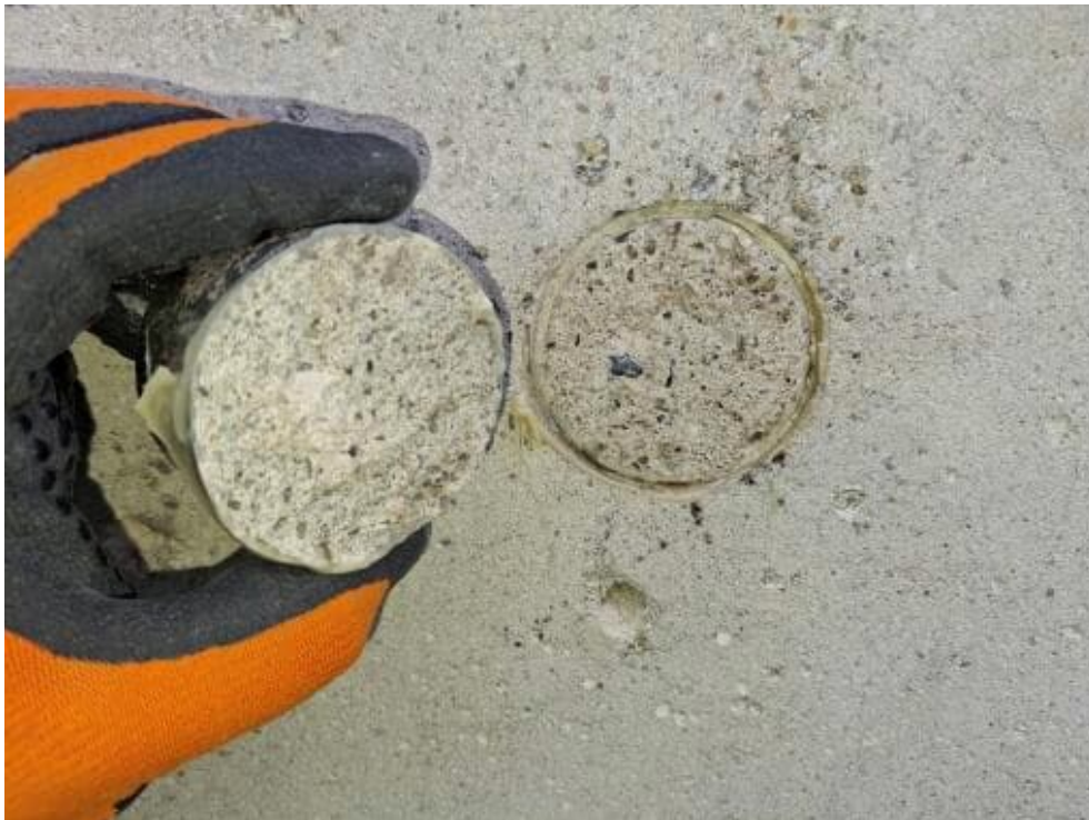
Bild 71: N35 Haftzugprüfung HZ3, ID 113, Abreißfestigkeit 3,76 N/mm 2 Versagensbild: 95% Kohäsion 5% Adhäsion
