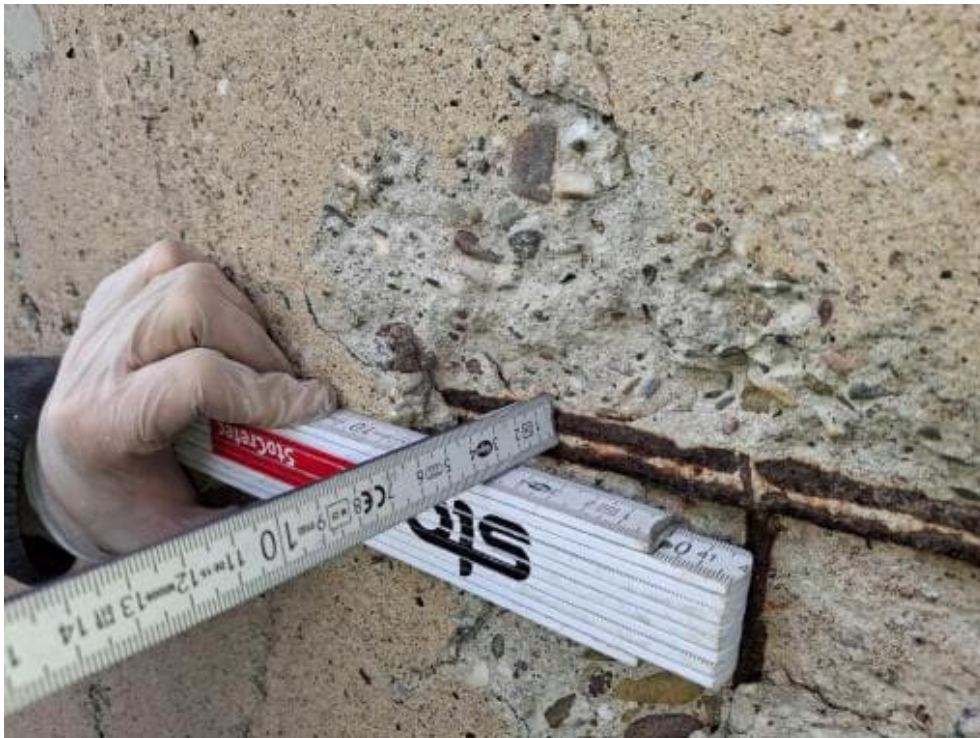
Bild 85: N41 Karbonatisierungsprüfung K9, K = 29-40 mm, Betondeckung cv = 32 mm, ch = 20 mm
