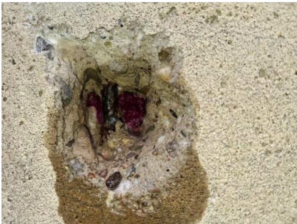
Bild 54: N29 Karbonatisierungsprüfung K5, K = 50 mm, Betondeckung c = 40 mm
