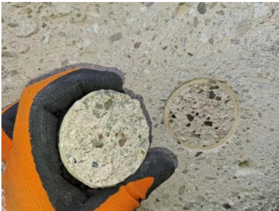
Bild 124: N55 Haftzugprüfung HZ10, ID 120, Abreißfestigkeit 1,72 N/mm 2 Versagensbild: 100% Kohäsion
