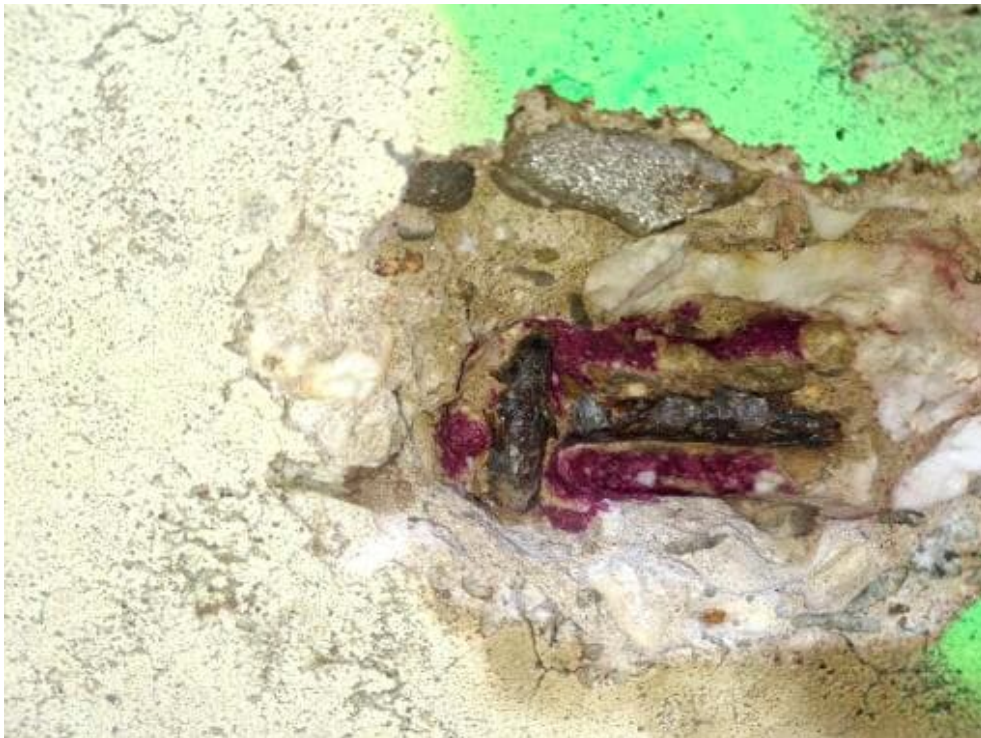
Bild 63: N32 Karbonatisierungsprüfung K8, K = 45 mm, Betondeckung cv = 29 mm, ch = 39 mm
