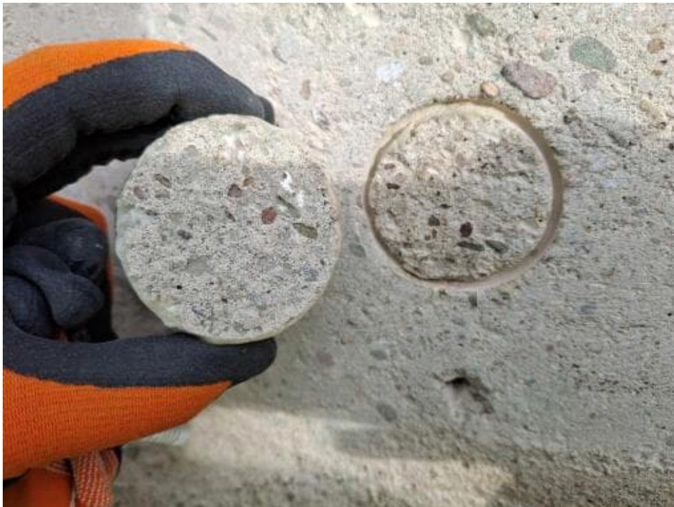
Bild 67: N33 Haftzugprüfung HZ1, ID 111, Abreißfestigkeit 1,91 N/mm 2 Versagensbild: 90% Kohäsion 10% Adhäsion
