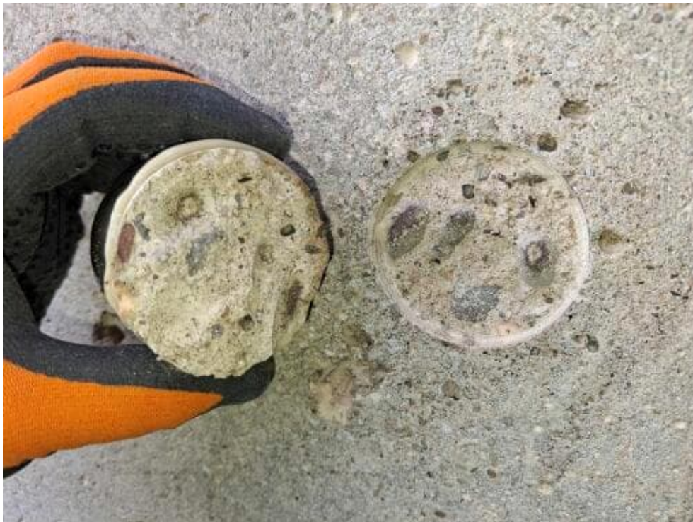
Bild 77: N38 Haftzugprüfung HZ6, ID 116, Abreißfestigkeit 3,41 N/mm 2 Versagensbild: 100% Kohäsion
