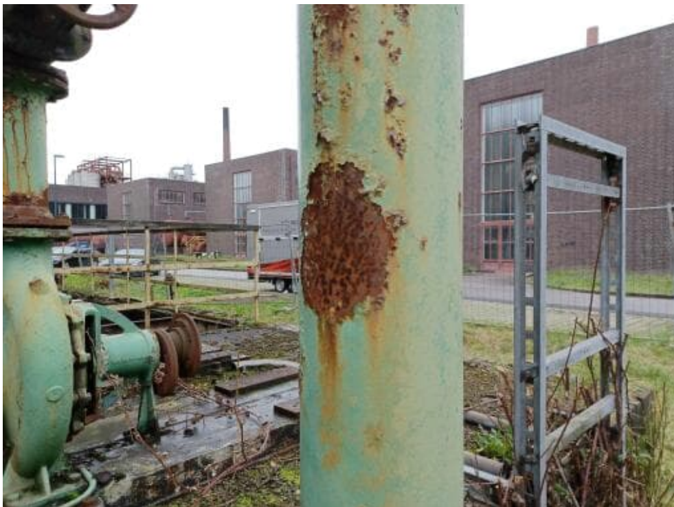
Bild 2: N2 Probe S1 Schadstoffanalyse Korrosionsschutzbeschichtung
