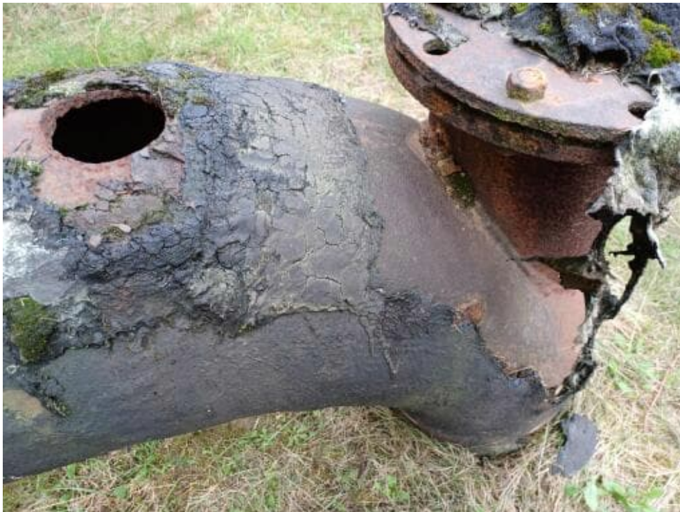
Bild 3: N3 Probe S2 Schadstoffanalyse Korrosionsschutzbeschichtung
