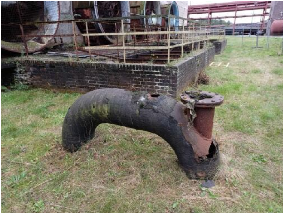
Bild 4: N3 Probe S2 Schadstoffanalyse Korrosionsschutzbeschichtung
