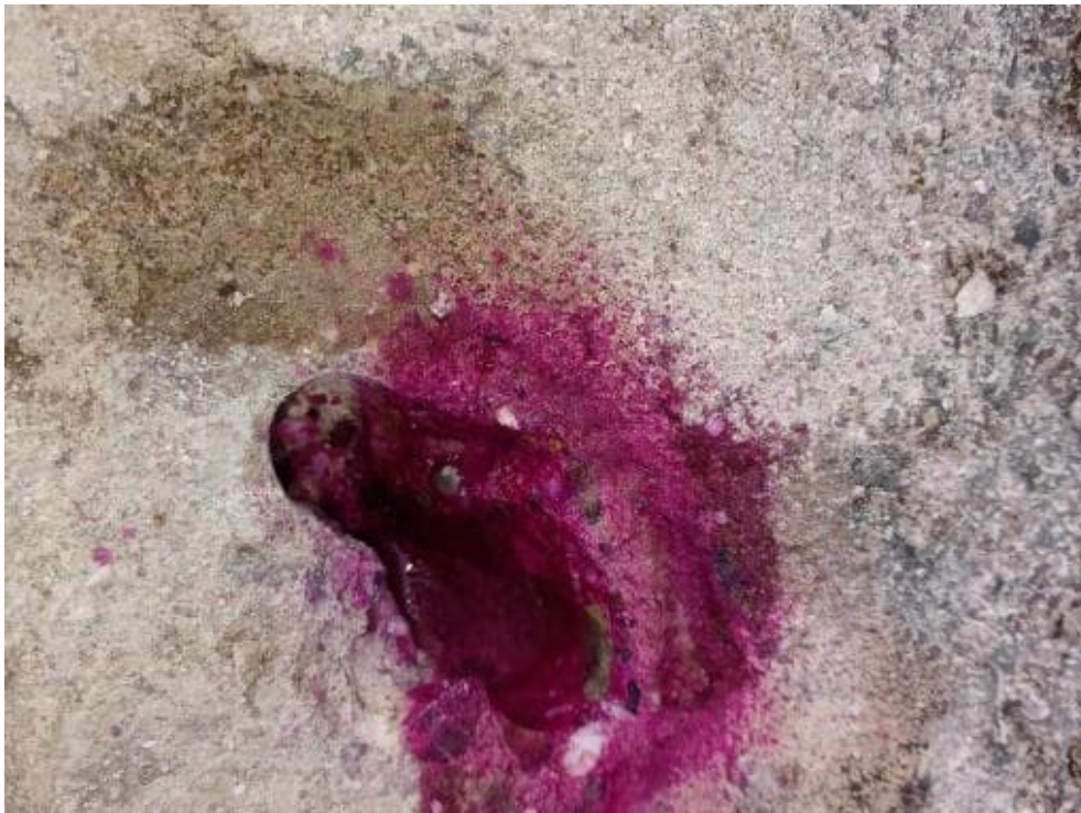
Bild 37: N22 Bohrmehlentnahme 0-20, 20-40 CI7.1 und CI7.2, Karbonatisierung K < 1\text{mm} Kragplatte, Mörtel vorher entfernt.
