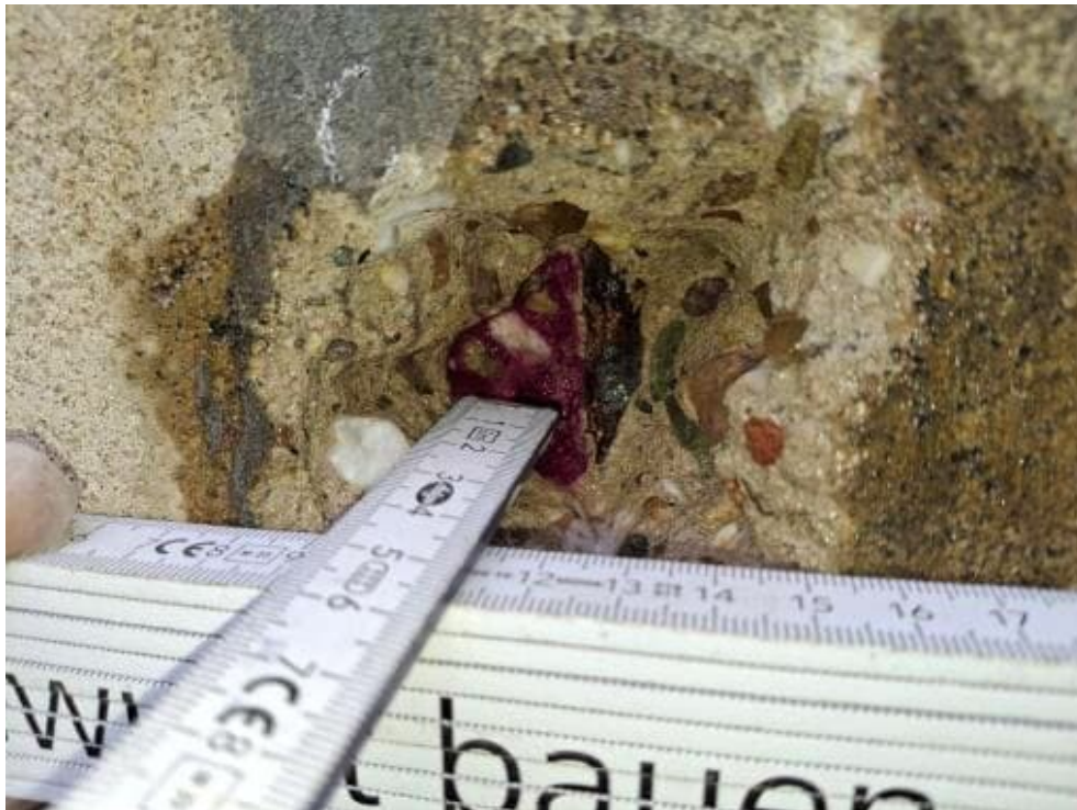
Bild 53: N28 Karbonatisierungsprüfung K4, K \geq 38 mm, Betondeckung c = 42 mm
