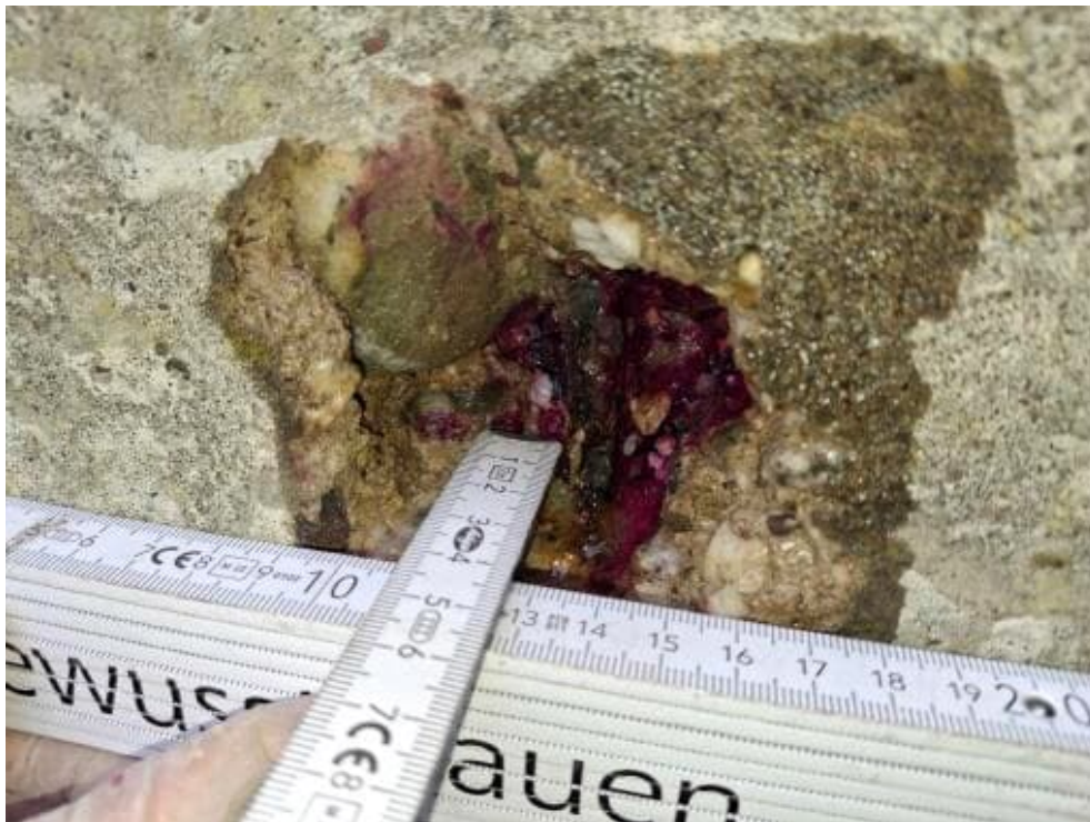
Bild 48: N26 Karbonatisierungsprüfung K2, K = 24-35 mm, Betondeckung c = 35 mm
