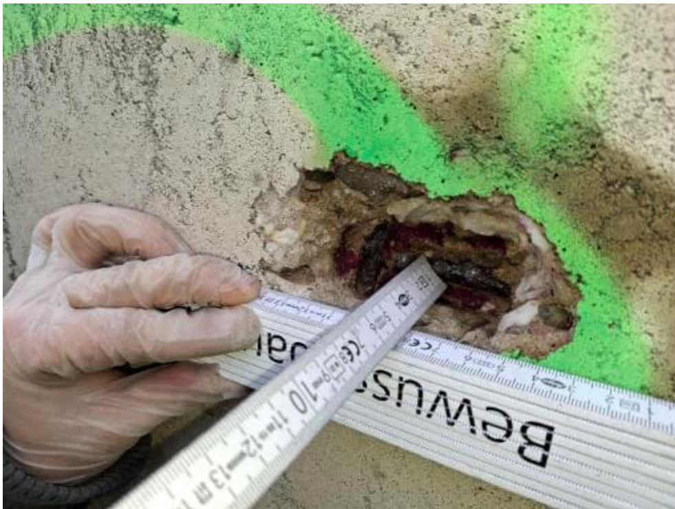
Bild 64: N32 Karbonatisierungsprüfung K8, K = 45 mm, Betondeckung cv = 29 mm, ch = 39 mm
