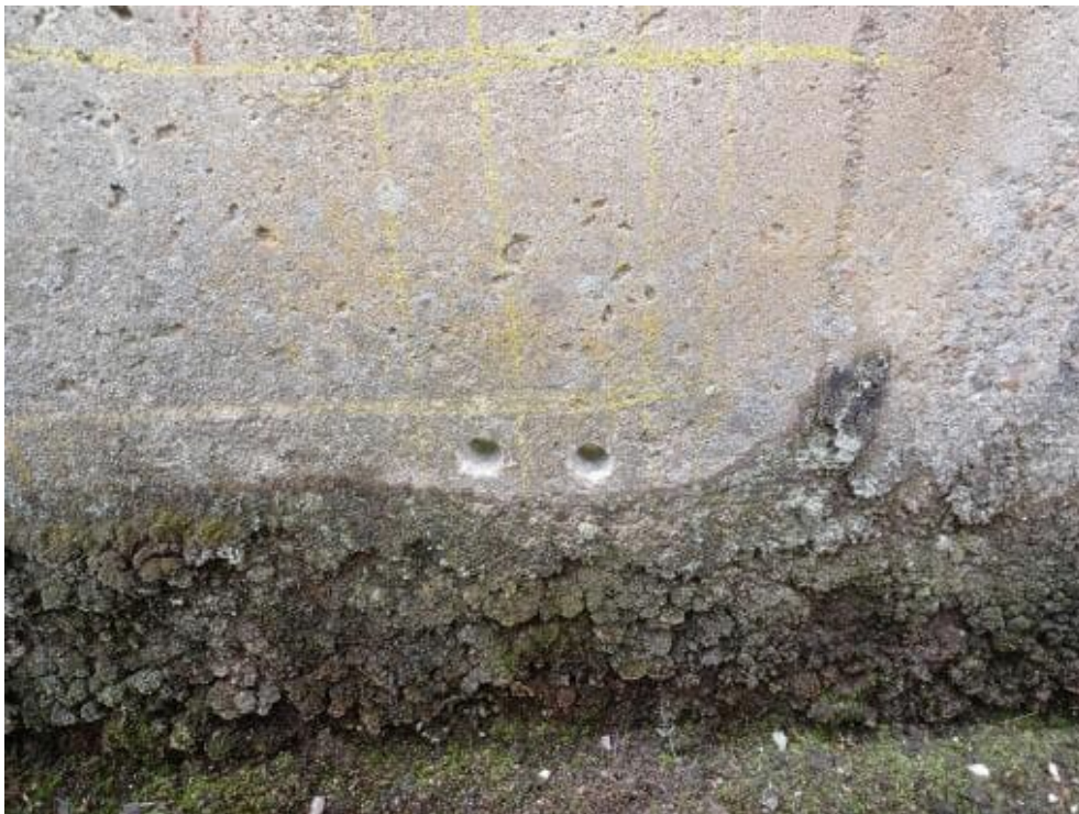
Bild 10: N7 Bohrmehlentnahme 0-20, 20-40 mm CI 2.1 und CI2.2
