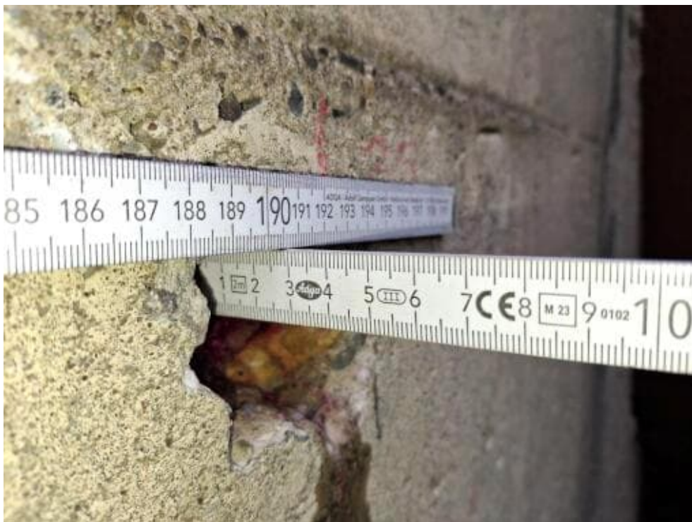
Bild 44: N24 Karbonatisierungsprüfung K1, K = 24-28 mm, Betondeckung c = 30 mm
