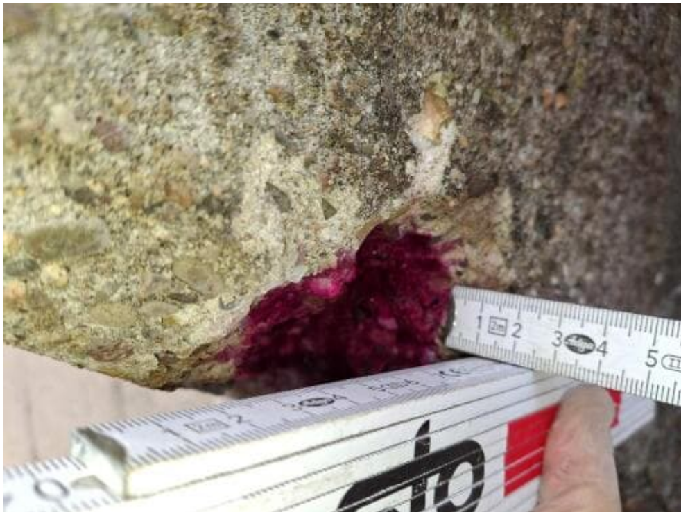
Bild 107: N48 Karbonatisierungsprüfung K10, K = 10 mm, Betondeckung c_v = 10 mm
