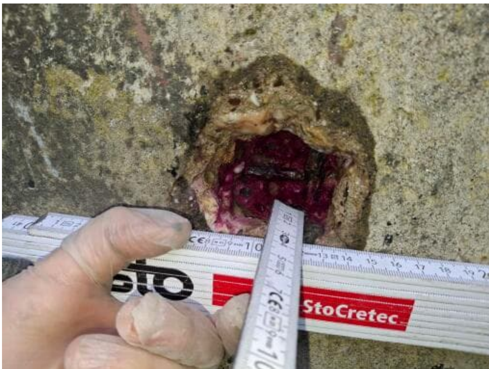
Bild 62: N31 Karbonatisierungsprüfung K7, K = 27 mm, Betondeckung cv = 35 mm, ch = 44 mm
