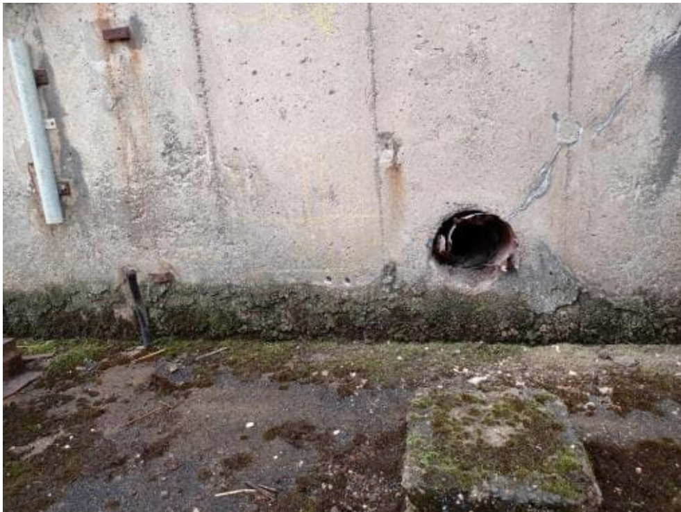
Bild 11: N7 Bohrmehlentnahme 0-20, 20-40 mm CI 2.1 und CI2.2
