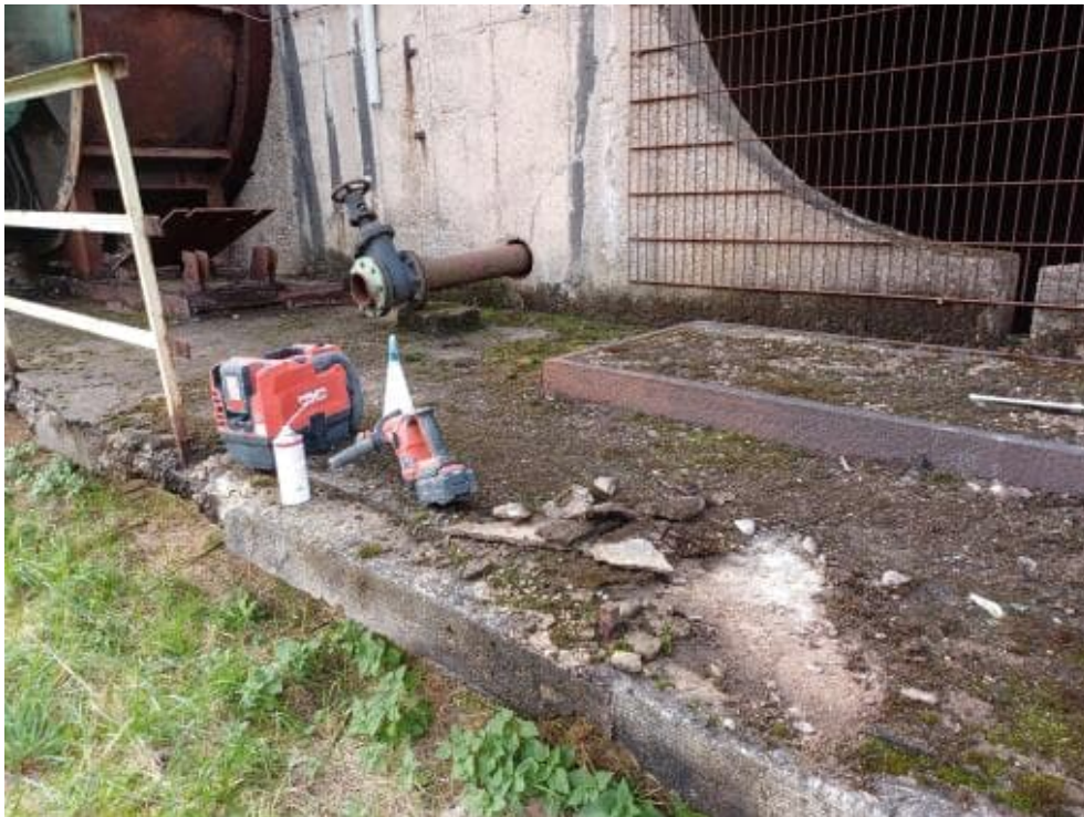
Bild 41: N23 Bohrmehlentnahme 0-20, 20-40 Cl8.1 und Cl8.2, Karbonatisierung K < 1\text{mm} Kragplatte, Mörtel vorher entfernt
