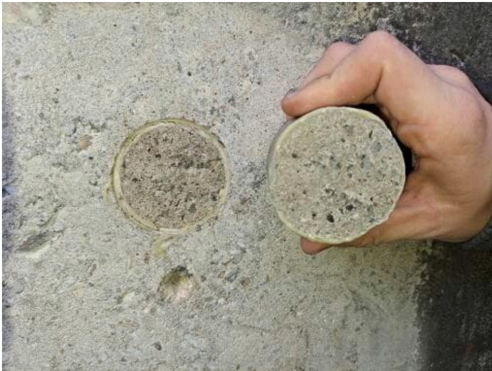
Bild 79: N39 Haftzugprüfung HZ7, ID 117, Abreißfestigkeit 3,93 N/mm 2 Versagensbild: 90% Kohäsion 10% Adhäsion
