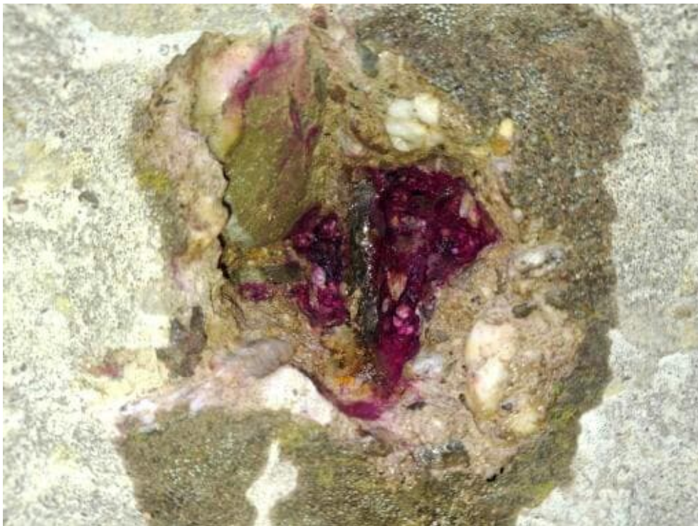
Bild 46: N26 Karbonatisierungsprüfung K2, K = 24-35 mm, Betondeckung c = 35 mm
