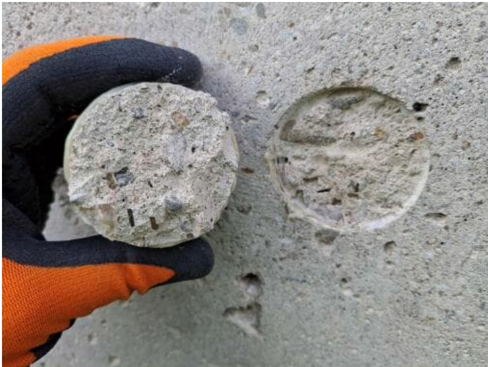
Bild 69: N34 Haftzugprüfung HZ2, ID 112, Abreißfestigkeit 2,31 N/mm 2 Versagensbild: 100% Kohäsion
