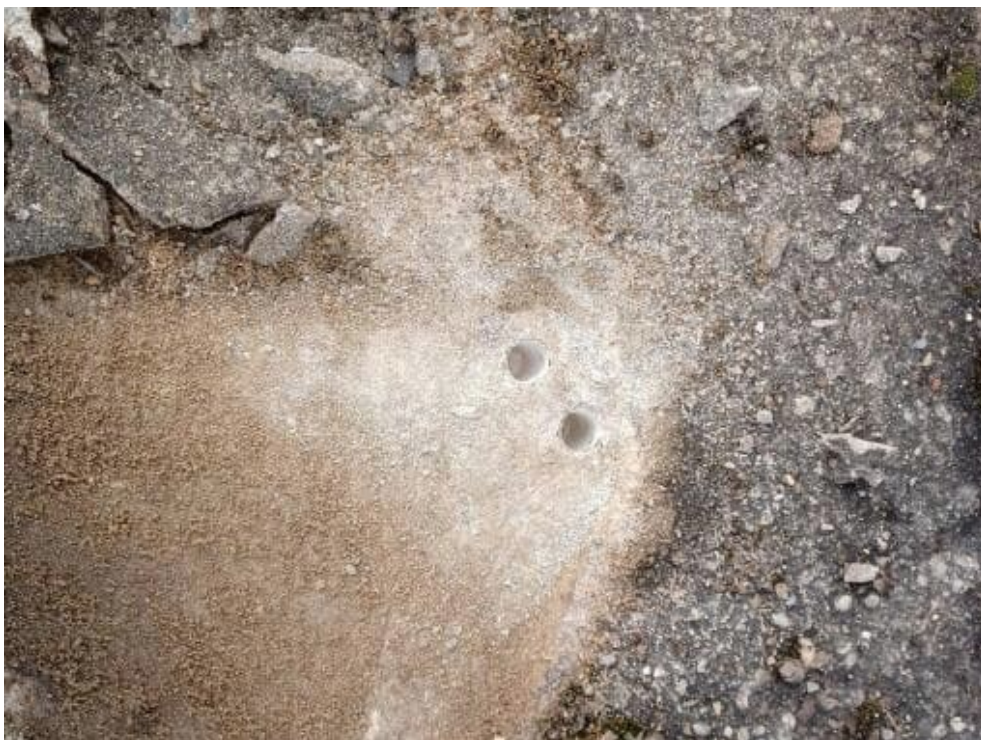
Bild 38: N22 Bohrmehlentnahme 0-20, 20-40 CI7.1 und CI7.2, Karbonatisierung K < 1\text{mm} Kragplatte, Mörtel vorher entfernt.
