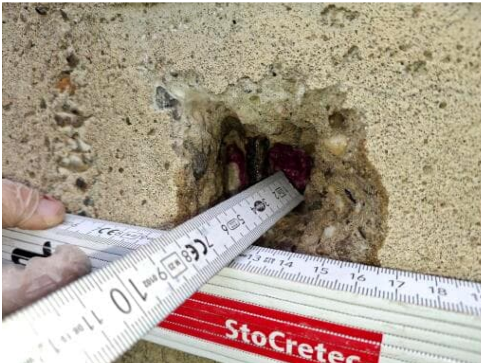
Bild 56: N29 Karbonatisierungsprüfung K5, K = 50 mm, Betondeckung c = 40 mm
