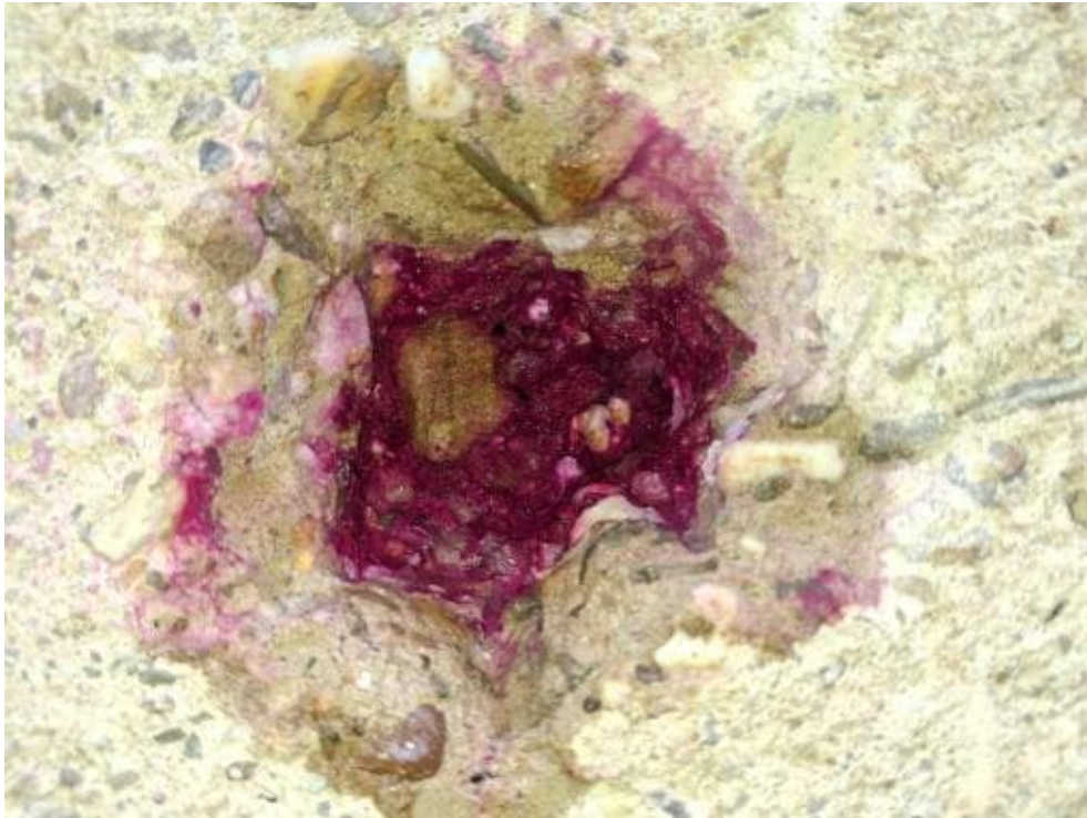
Bild 49: N27 Karbonatisierungsprüfung K3, K = 25-33 mm, Betondeckung c = 24 mm
