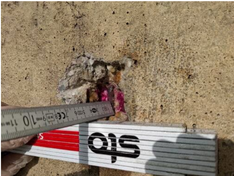
Bild 86: N41 Karbonatisierungsprüfung K9, K = 29-40 mm, Betondeckung cv = 32 mm, ch = 20 mm
