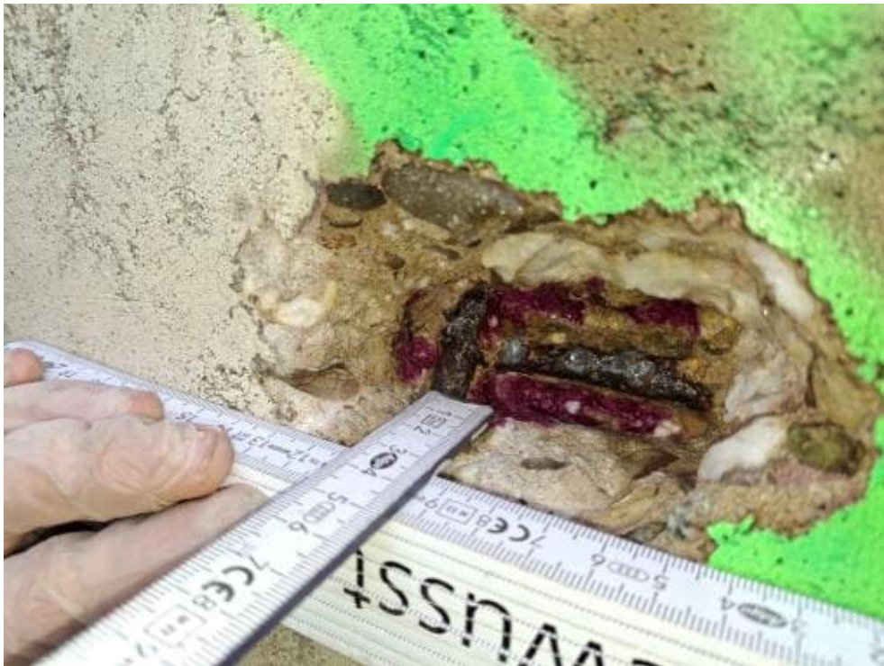
Bild 65: N32 Karbonatisierungsprüfung K8, K = 45 mm, Betondeckung cv = 29 mm, ch = 39 mm
