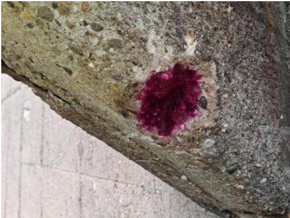
Bild 105: N48 Karbonatisierungsprüfung K10, K = 10 mm, Betondeckung cv = 10 mm
