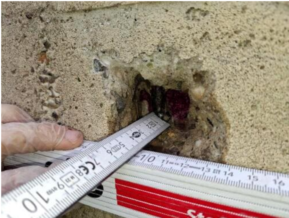
Bild 55: N29 Karbonatisierungsprüfung K5, K = 50 mm, Betondeckung c = 40 mm
