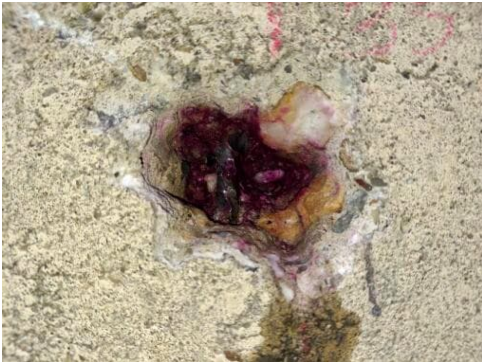
Bild 43: N24 Karbonatisierungsprüfung K1, K = 24-28 mm, Betondeckung c = 30 mm
