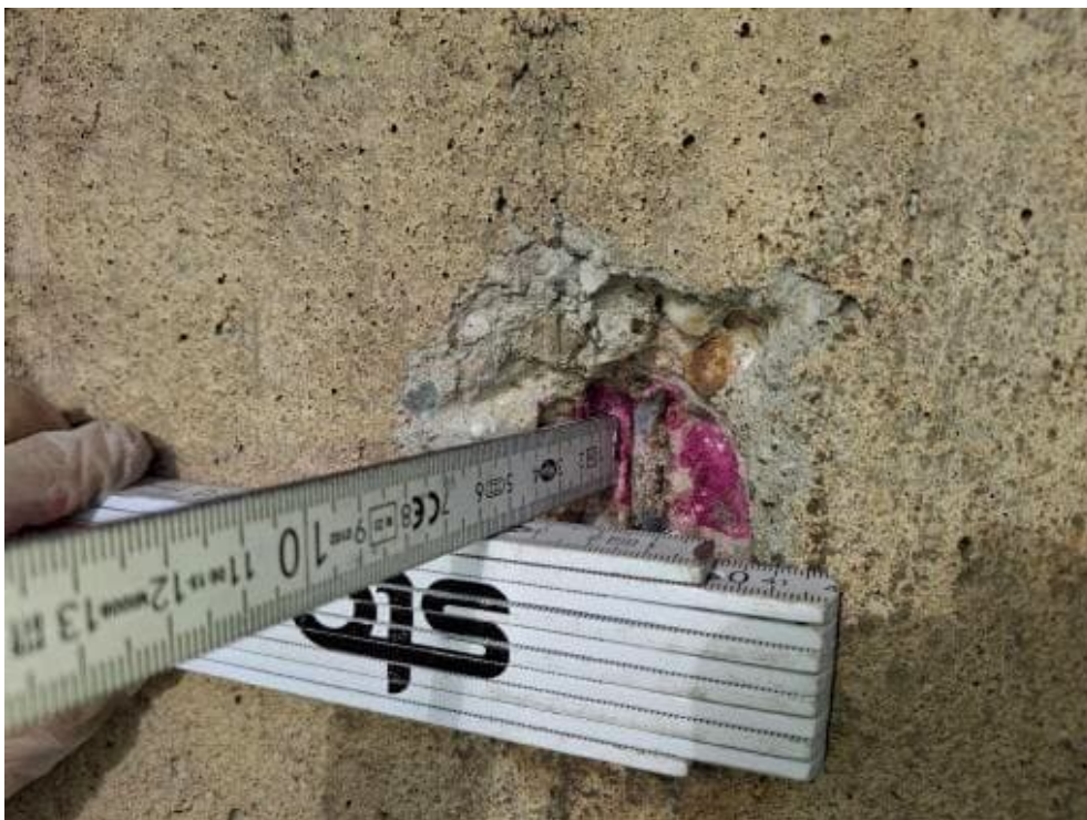
Bild 84: N41 Karbonatisierungsprüfung K9, K = 29-40 mm, Betondeckung cv = 32 mm, ch = 20 mm
