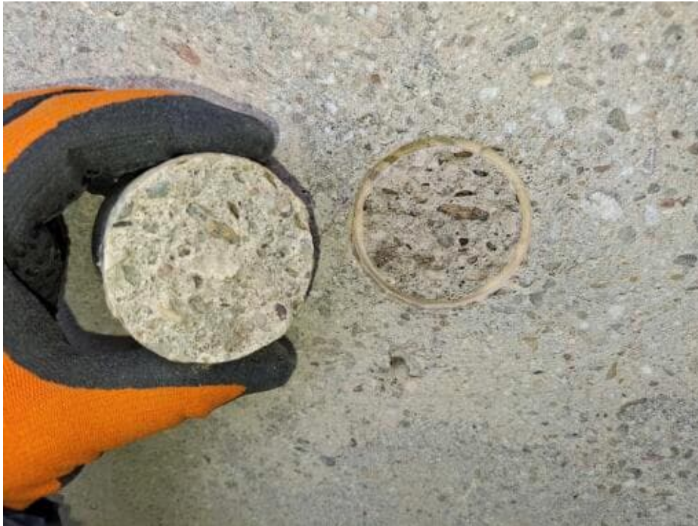
Bild 75: N37 Haftzugprüfung HZ5, ID 115, Abreißfestigkeit 1,72 N/mm 2 Versagensbild: 100% Kohäsion
