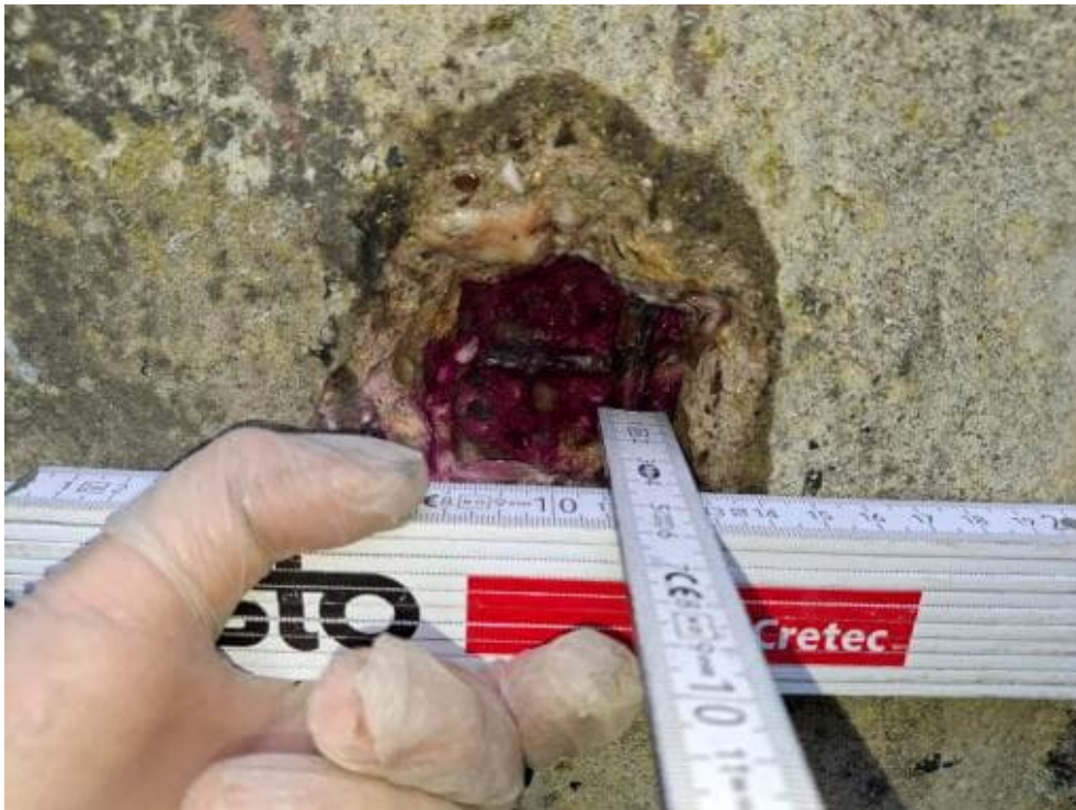
Bild 61: N31 Karbonatisierungsprüfung K7, K = 27 mm, Betondeckung cv = 35 mm, ch = 44 mm
