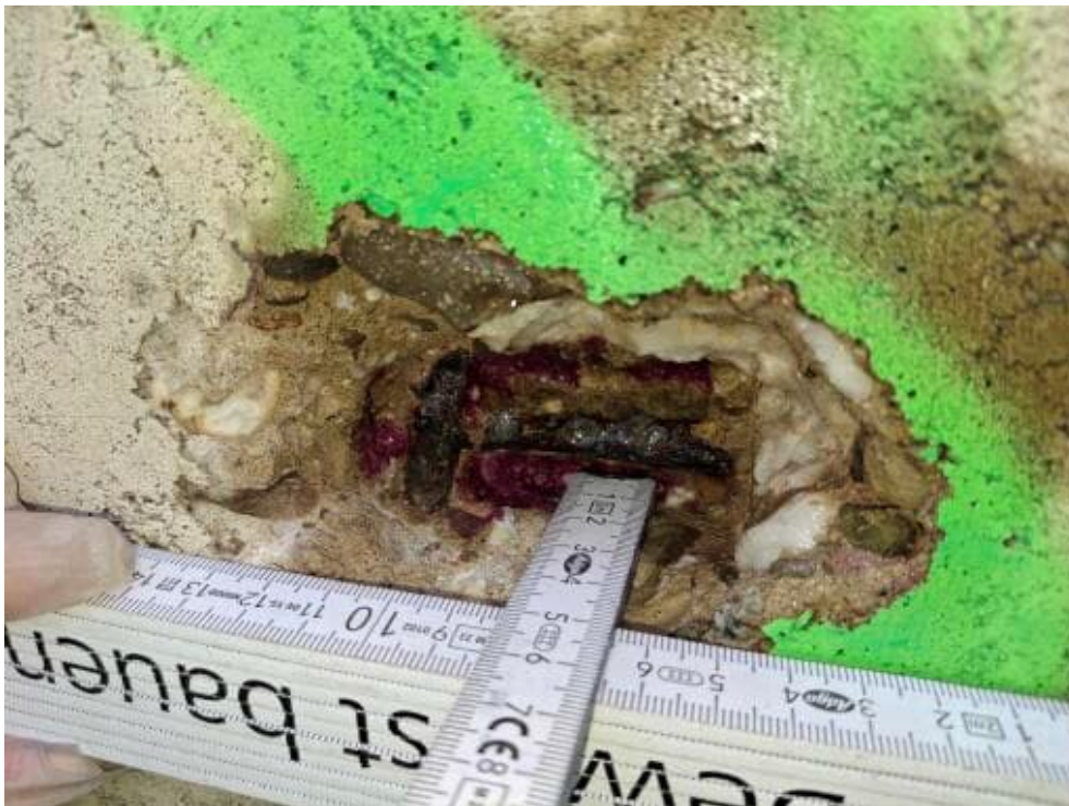
Bild 66: N32 Karbonatisierungsprüfung K8, K = 45 mm, Betondeckung cv = 29 mm, ch = 39 mm
