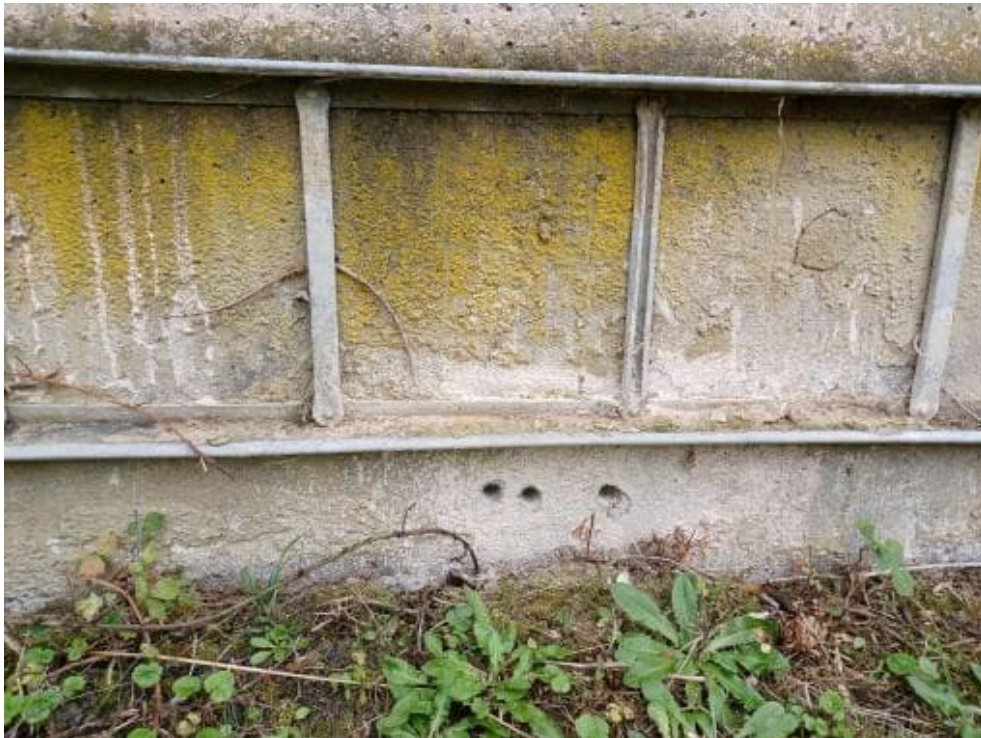
Bild 1: N1 Bohrmehlentnahme 0-20, 20-40 mm CI 1.1 und 1.2
