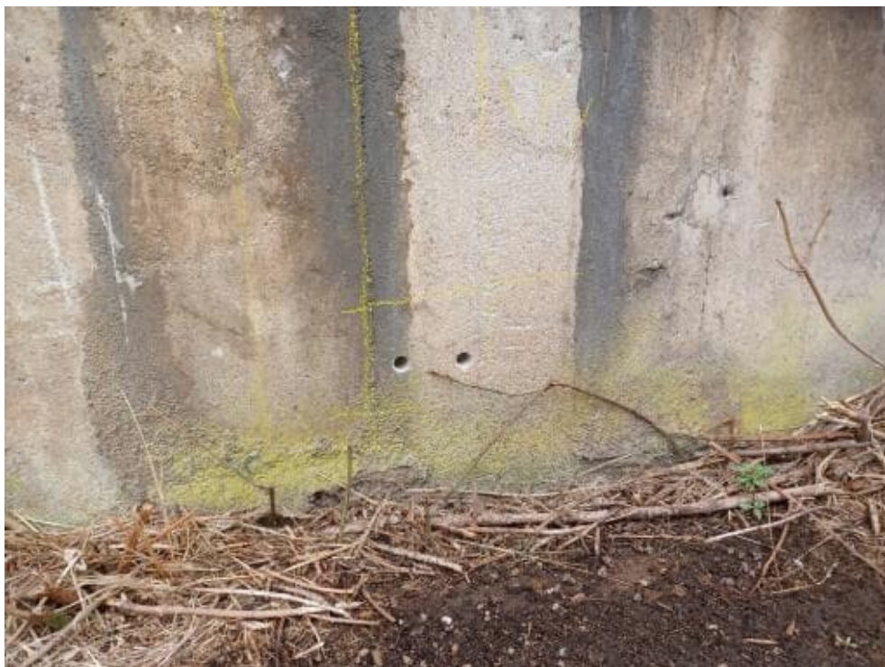
Bild 14: N9 Bohrmehlentnahme 0-20, 20-40 mm CI 4.1 und 4.2
