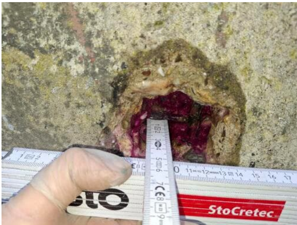
Bild 60: N31 Karbonatisierungsprüfung K7, K = 27 mm, Betondeckung c_v = 35 mm, c_h = 44 mm
