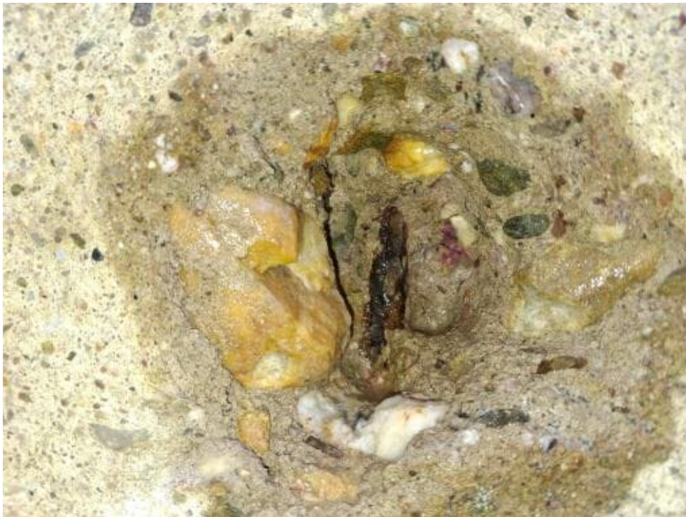
Bild 57: N30 Karbonatisierungsprüfung K6, K = >45 mm, Betondeckung c = 38 mm
