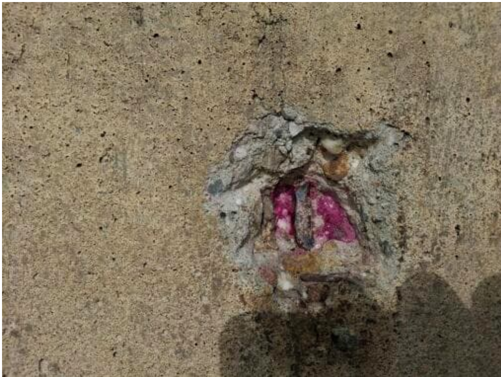
Bild 83: N41 Karbonatisierungsprüfung K9, K = 29-40 mm, Betondeckung cv = 32 mm, ch = 20 mm
