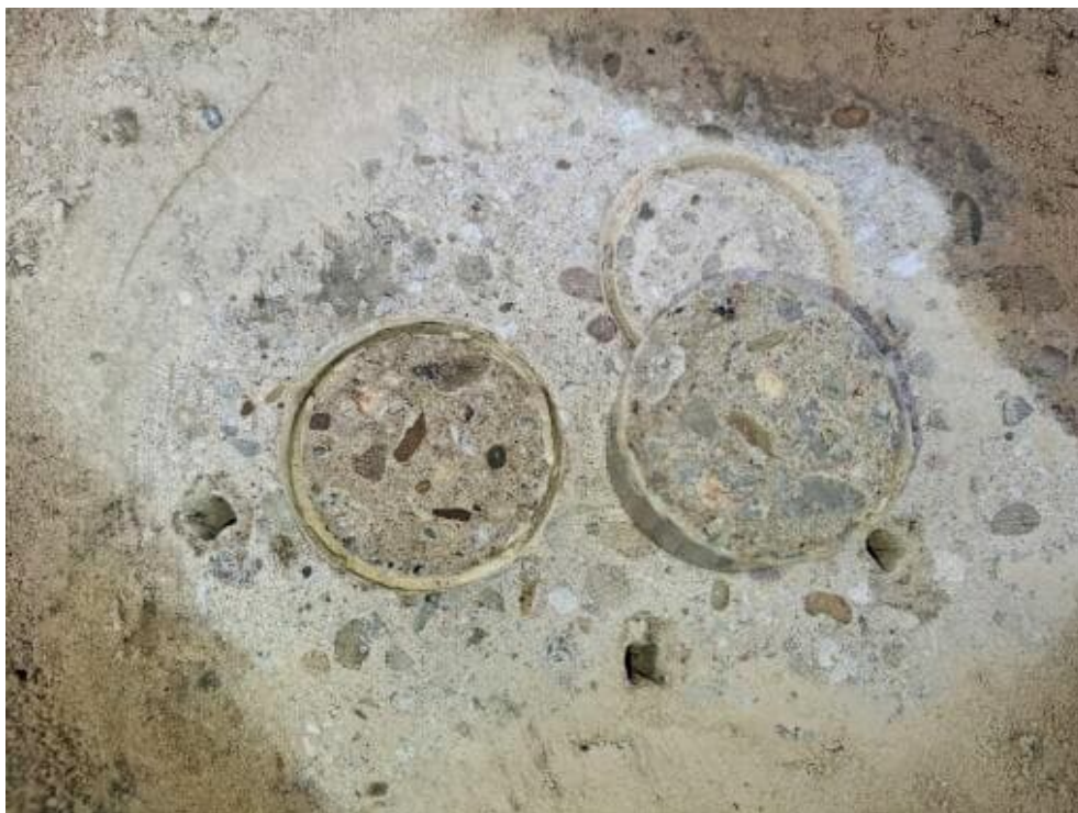
Bild 134: N58 Haftzugprüfung HZ11, ID 121, Abreißfestigkeit 2,47 N/mm 2 Versagensbild: 75% Kohäsion 25% Adhäsion
