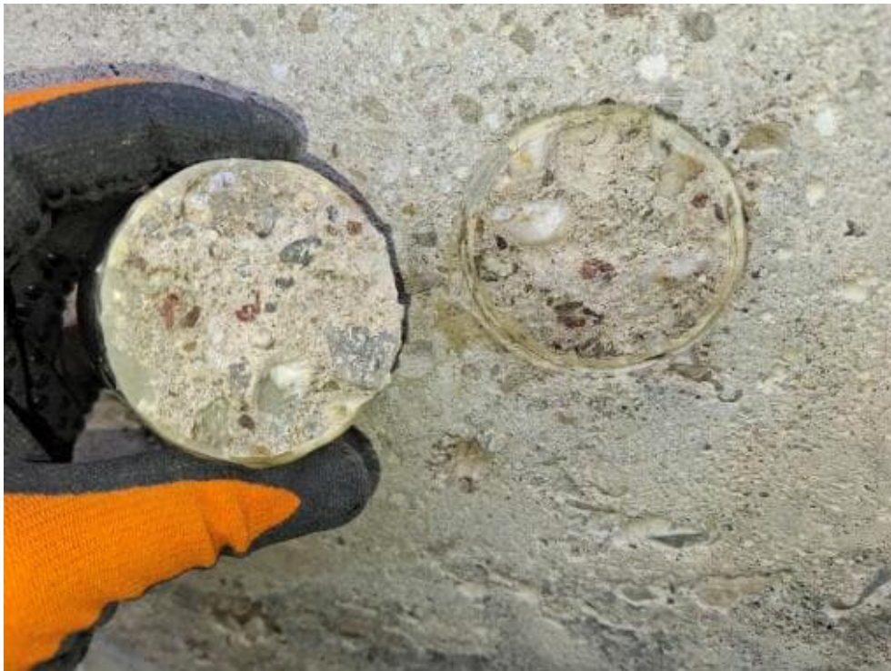
Bild 81: N40 Haftzugprüfung HZ8, ID 118, Abreißfestigkeit 3,08 N/mm 2 Versagensbild: 80% Kohäsion 20% Adhäsion
